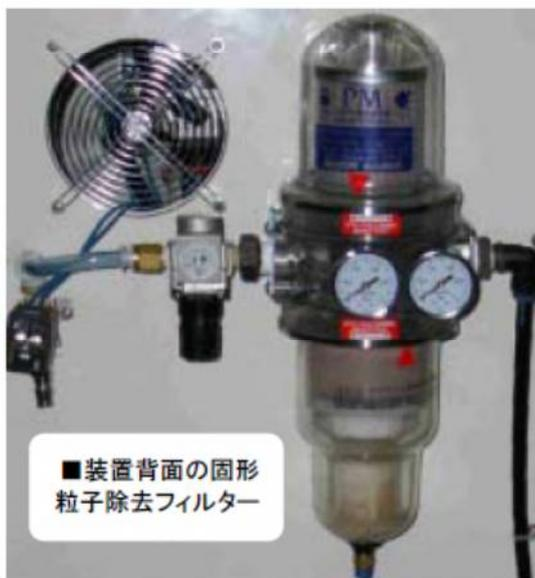
■装置背面の固形粒子除去フィルター
