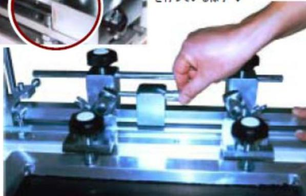
●固定ノブにより印刷版の枠部分をしっかりとホールドします。
